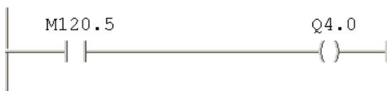
На рисунке слева вы видите пример управления лампочкой с помощью синхробита M120.5 с частотой 1 Гц. Для изменения частоты достаточно выбрать другой номер синхробита.
